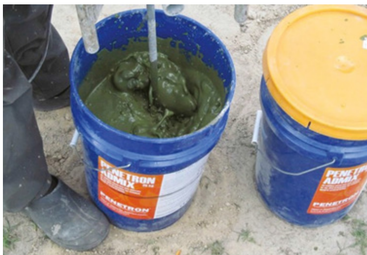
Рисунок 7.1.1 – Гидроизоляционная добавка «Пенетрон Адмикс» перед ее введением в бетонную смесь
